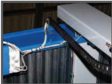
Tout le câblage de la machine est bien protégée par une caténaire en PVC qui protège contre d'éventuels broyages des câbles électriques pendant le mouvement de la machine, en assurant un degré de sécurité globale et la sauvegarde du système électrique.
