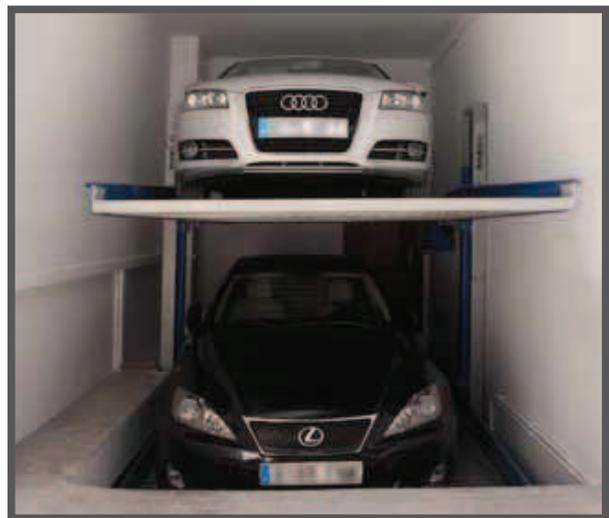
Le doubleur de parking Spacer 25/2 est équipé de barre de torsion, qui se est situé dans la partie inférieure de la première plateforme, avec la fonction de stabiliser le poids sur les plateformes mêmes. Grâce à la barre du haut, il n'es pas nécessaire d'équilibrer le poids, et la machine sera capable de soulever deux voitures, quelle que soit la façon dont ils sont garées.
